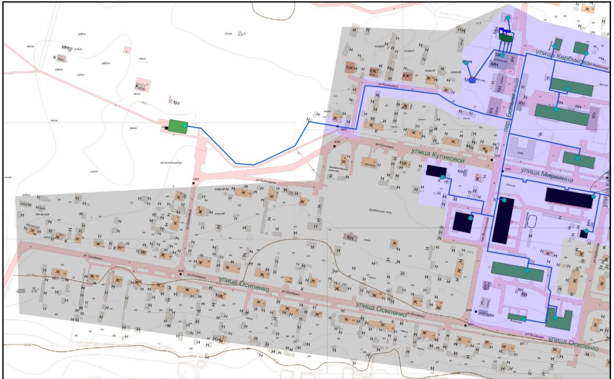
Рисунок 1.5. Схема водоснабжения по ул. Куликовой, Осипенко, Мирюгина, переулка Больничного и аэропорта
